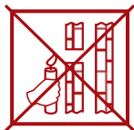
слабая тяга (Не используйте котел!)
